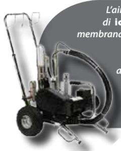
L'airless è un macchinario che permette l'applicazione di **icoper®** a spruzzo: esistono pompe a pistone o a membrana che, per mezzo di un pescante, permettono l'aspirazione diretta del prodotto dal suo contenitore. La mandata del prodotto avviene per compressione, senza utilizzo di aria. L'applicazione ad airless garantisce una maggiore produttività nella fase applicativa: resa giornaliera (2 persone/8 h) 800 - 1000 mq.
