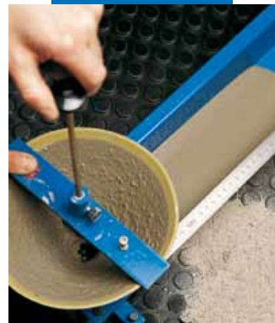
Prova di scorrimento secondo EN 13395-2
