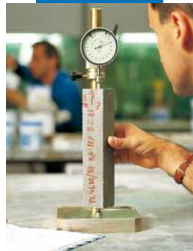
Determinazione dell'espansione contrastata secondo UNI 8147
